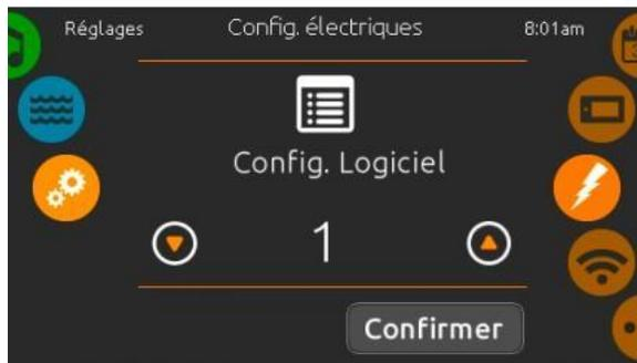
Veillez noter que s'il y a deux contrôleurs de spa dans le système (c.-à-d. installation du SwimSpa), la configuration de l'unité maître doit supporter une unité esclave. Si, après redémarrage, la configuration sélectionnée ne supporte pas l'installation du SwimSpa, le in.k1000 retournera (après environ 45 secondes) à ce menu de configuration et demandera à l'utilisateur de sélectionner un numéro de configuration de nouveau.
